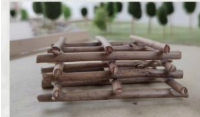
ENROCAMENTO VIVO - VISTA FRONTAL
